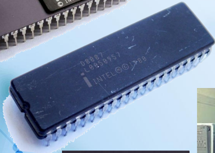
Intel 8087. Математический сопроцессор для Intel 8086. 1980 год
