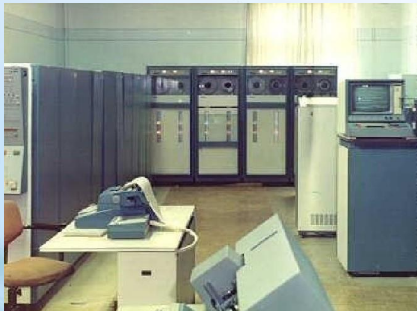
Комплект ЕС ЭВМ 1022. 1972 год Размеры шкафа процессора: 1,2м x 0,75м x 1,6м
