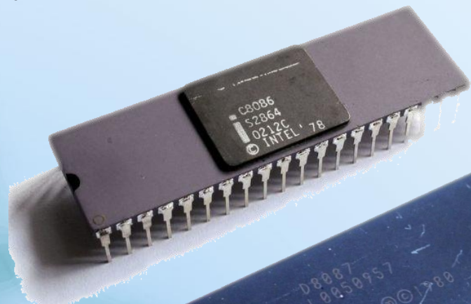
16-ти битный процессор Intel 8086. IBM PC-XT. 1978 год
